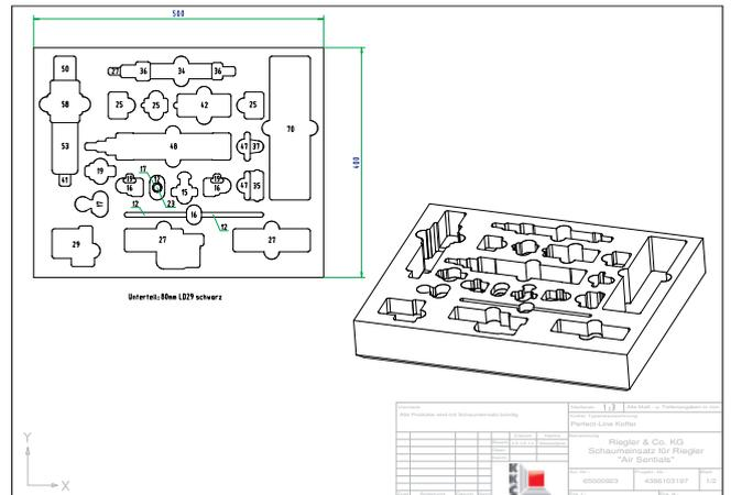
Die einzelnen Produktteile, die im Schaum platziert werden sollen, geben die Nestkontur vor. Mittels CAD-Programm wird die einzelne Produkt-Nestform ermittelt. Die optimale Anordnung der Produkte bzw. Nestformen für die Einlage erfolgt auf der entstehenden CAD-Zeichnung.
