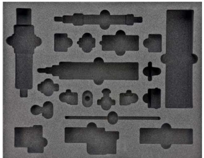
Aus einem Schaumstoffblock wird die gemäß Zeichnung so erfasste Form in der CNC-Fräse herausgearbeitet. Die Einlagenform ist so auch bei hohen Stückzahlen in gleichbleibender Qualität durch diese maschinelle Fertigung reproduzierbar.
