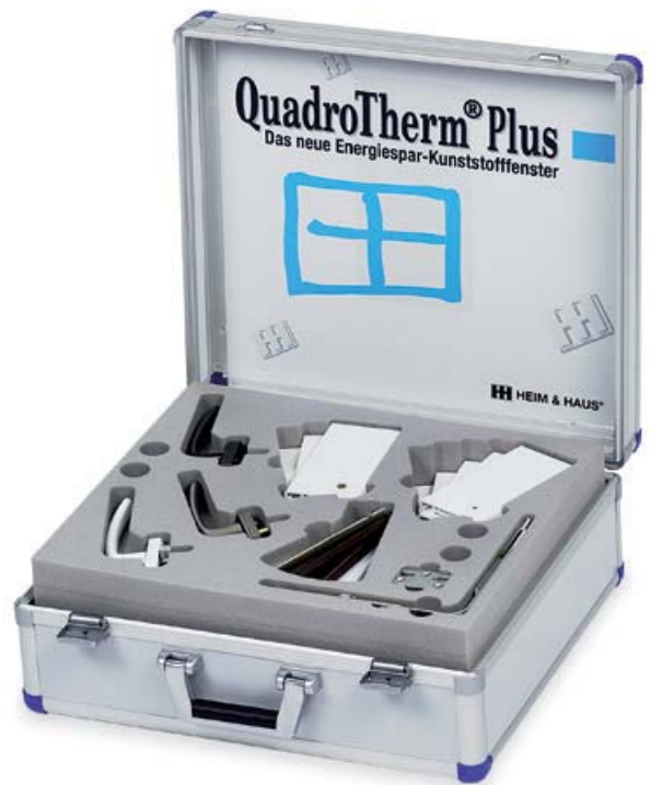
K Koffer, Laminatoberfläche Silbergrau Oslo Nr. 475, im Deckel 3-farbiger Siebdruck, Boden mit gestanzter Hartschaumeinlage aus LD 29 in Schwarz, darüber ein herausnehmbares Schaumtableau aus Hartschaumstoff LD 45 in Hellgrau.
