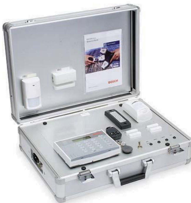
K Koffer met montageplaat in het deksel, frontplaat in het bodemdeel met bedrading van de componenten. Aan de buitenzijde een stroom- en computerstekker aansluiting.
