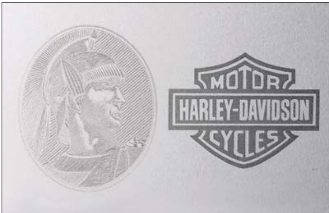
Lasergravur (nur auf Aluminiumblech)
