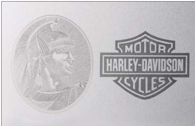
Gravure-laser (uniquement sur tôle d'aluminium)
